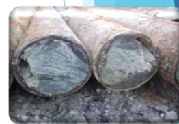
充填状況(施工実証)
