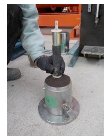
写真-2 山中式硬度 計による試験
